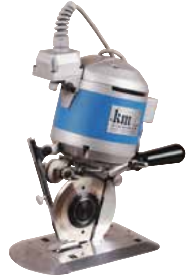
YUVARLAK KESİM MAKASI ROUND KNIFE CUTTING MACHINE Güç/Power : 220 Volt /500 Watt Kesim Yüksekliği Cutting Capacity : 85 mm Devir /Speed : 3. 000
