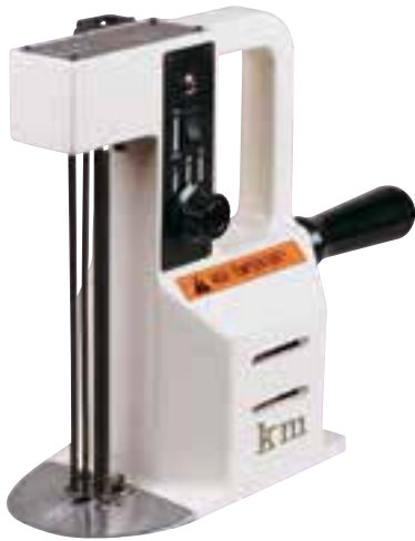
PASTAL İZ VE ÇİT MAKİNASI HOT NOTCHER MACHINE Güç/Power : 220 Volt /100 Watt Çit Yüksekliği Nach Capacity : 200 mm
